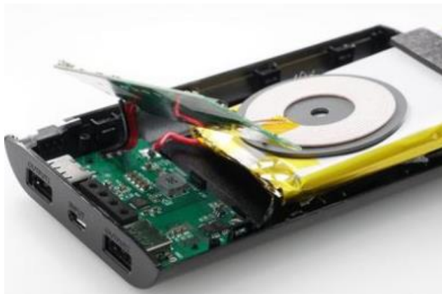
图 5-15 充电宝控制板
